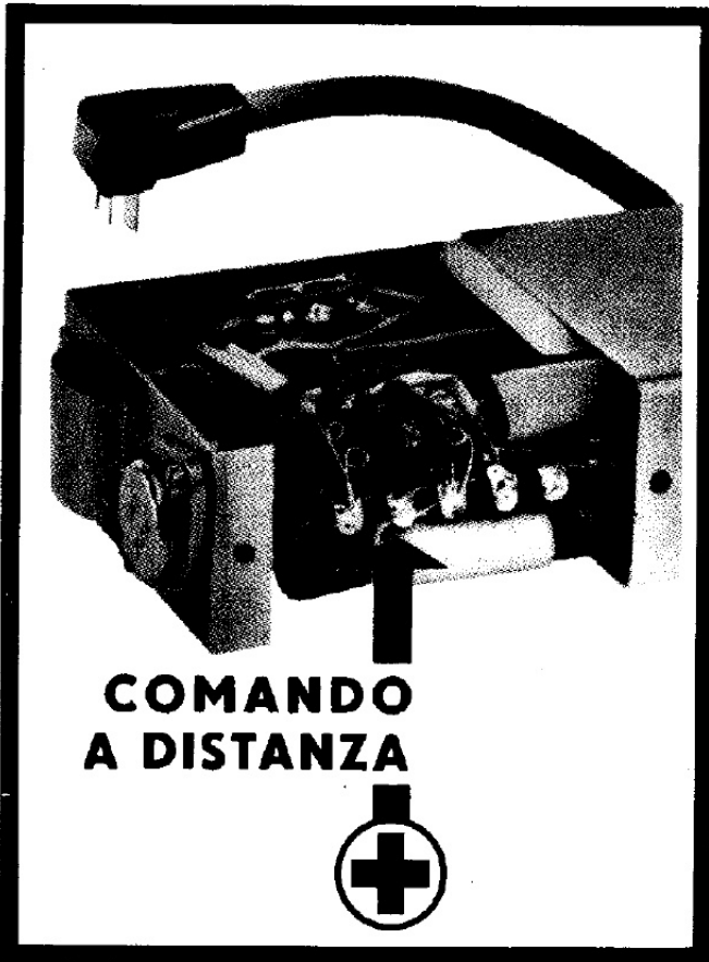
Fig. 4 - Il cavetto del comando a distanza per la sintonia elettronica, nelle vetture con impianto a 6 V (munite cioè di convertitore C 612) va connesso al +12 del convertitore nel punto qui indicato.
